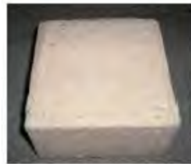
Pavés en béton poreux
